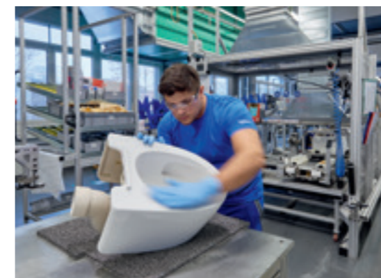
Montage von Dusch-WCs...
